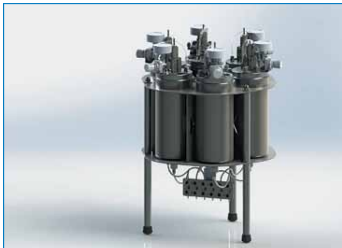
Рис. 10. Версия дозатора для одновременной расфасовки жидкостей в шесть флаконов
