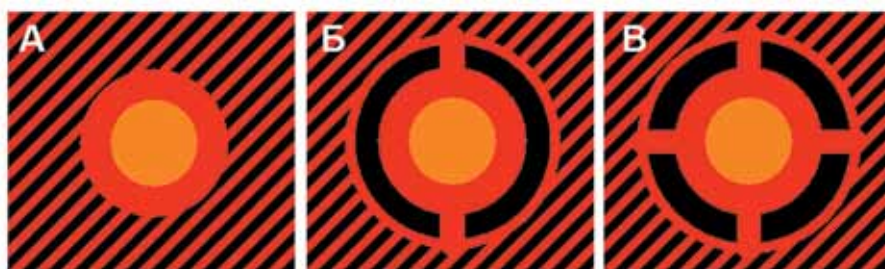
Рис. 2. Способы термального подключения переходных отверстий
