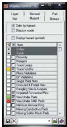
Рис. 12. Окно Display Control (закладка Hazard)
