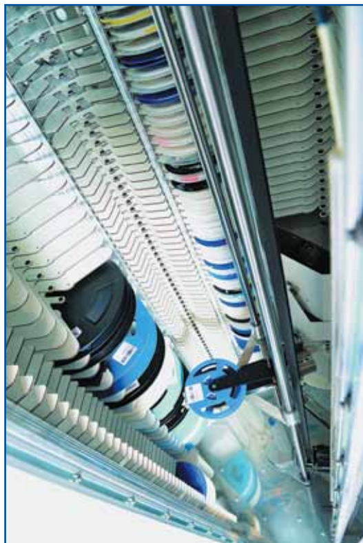
Рис. 1. SMD Tower позволяет хранить до 658 катушек или 725 поддонов
