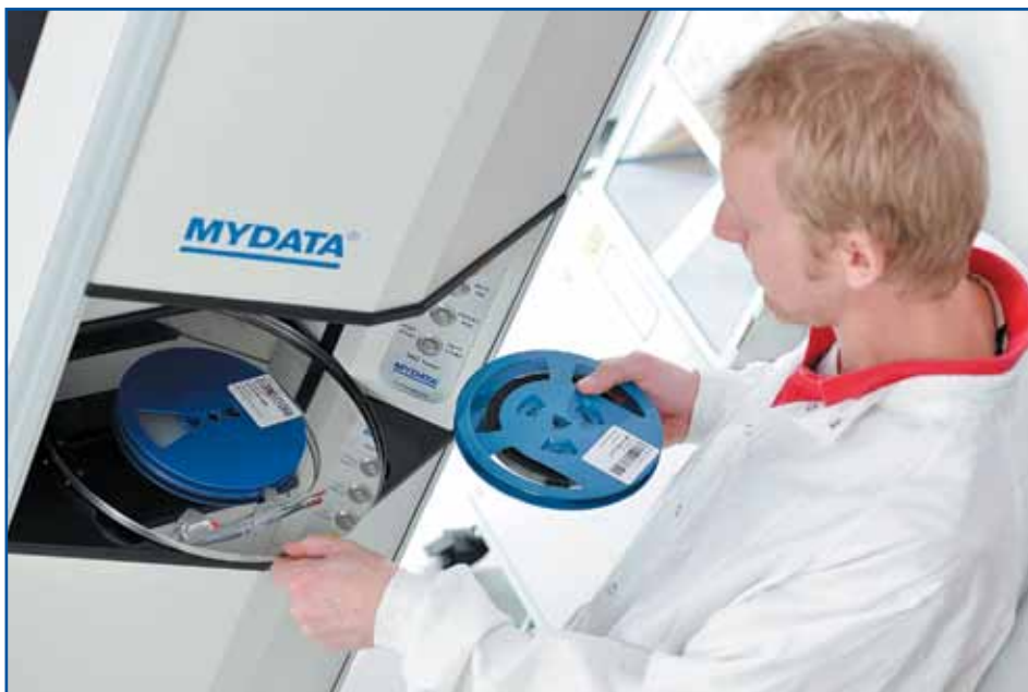
Рис. 2. Новые поддоны позволяют хранить катушки, уже заправленные в питатели Agilis
