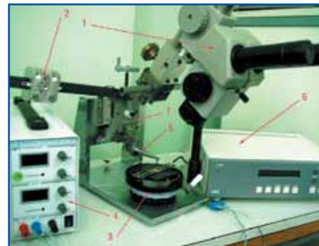
Рис. 5. Стенд термозвуковой сварки Flip-Chip:
