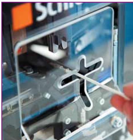
Рис. 3. Процесс обжатия контакта на прессе для обжима UniCrimp 200
