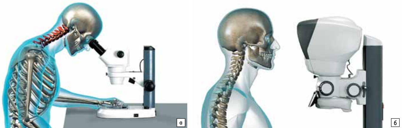
Рис. 2. Положение оператора: а) при работе со стандартной окулярной оптикой; б) при работе с безокулярной оптикой
