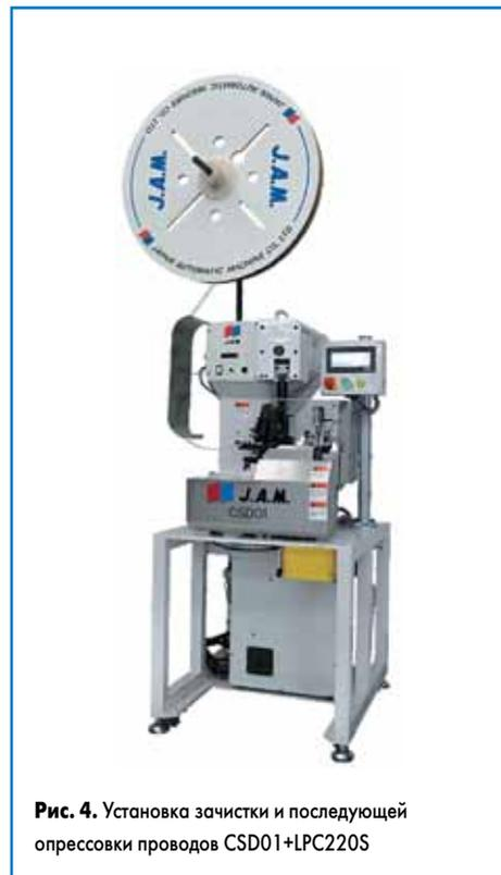
**Рис. 4.** Установка зачистки и последующей опрессовки проводов CSD01+LPC220S
