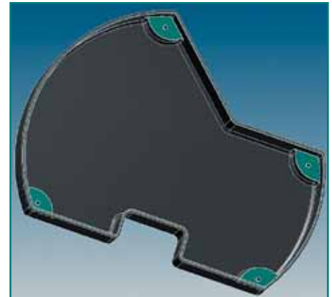
Рис. 3. Пример основания корпуса со сложной геометрией. (Голубым цветом выделены площадки, на которые будет опираться плата, и ребро, определяющее контур платы)
