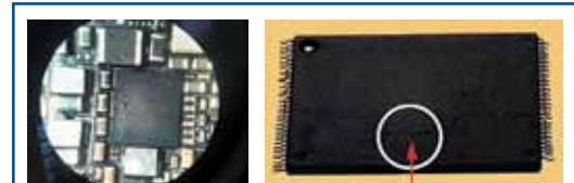
Рис. 2. Пример микротрещины корпуса микросхемы (дефект, недопустимый по стандарту IPC-A-610-E)
