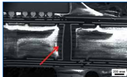
Рис. 1. Пример вздутия корпуса микросхемы (дефект, недопустимый по стандарту IPC-A-610-E)
