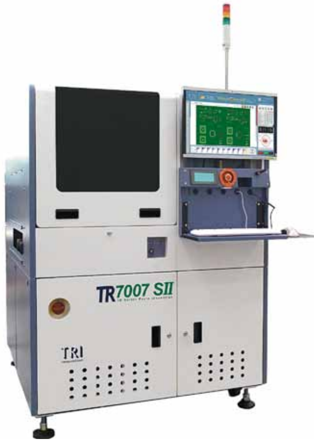
Рис. 10. Система 3D-инспекции качества нанесения пасты TR7007 от TRI
