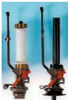
Рис. 4. Размотчик проволоки (шпуля) и технологическая катушка S24 (S16), на которую перематывается проволока для оплетения
