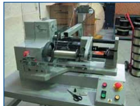
Рис. 6. Станок тростки луженой медной проволоки со стандартных катушек на пластиковую катушку установки Cobra 1000
