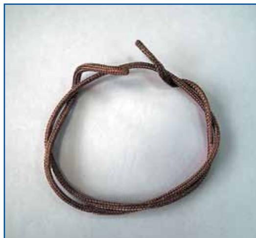
Рис. 1. Плетенка из алюминиевых сплавов, изготовленная на установке Cobra 1000
