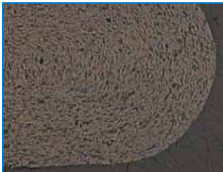
Рис. 2. Пример однородной структуры, необходимой для изготовления монтажных оснований изделий 3D-MID (источник: Multiple Dimensions)
