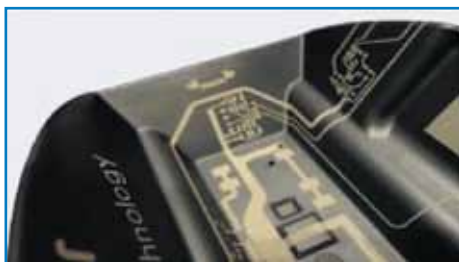
Рис. 3. Структурированная лазером пластиковая деталь (источник: Multiple Dimensions)
