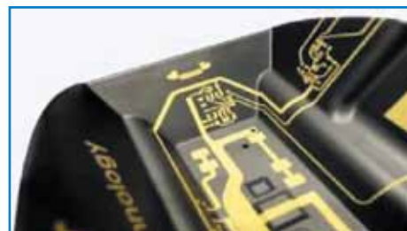
Рис. 5. Металлизированное монтажное основание (источник: Multiple Dimensions)
