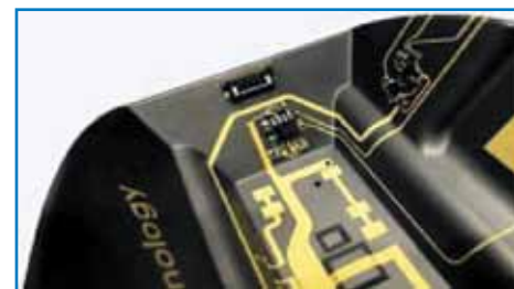
Рис. 8. Электронная сборка на монтажном основании, выполненном по технологии 3D-MID (источник: Multiple Dimensions)
