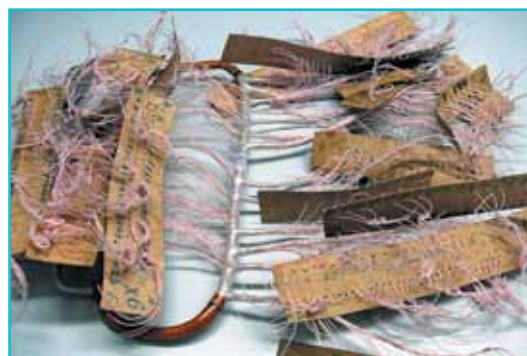
Рис. 1. Жгут с идентификацией проводов на картонной бирке
