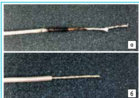
Рис. 10. Зачистка, подкрутка и лужение провода МГФФ (0,12 кв. мм): а) вручную; б) на автоматической линии
