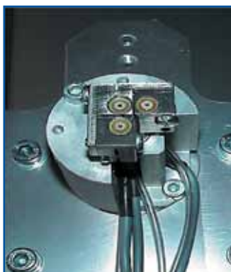
Рис. 3. Модуль микрокапельного флюсования с тремя насадками
