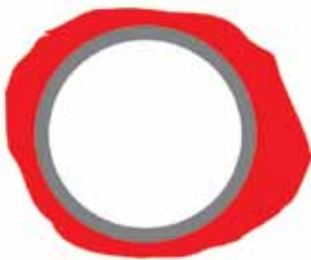
Рис. 9. Поток припоя при идеальном (серый) и неидеальном (красный) смачивании
