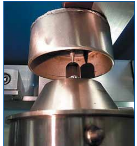
Рис. 12. Контроль высоты волны с помощью измерительной иглы
