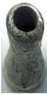
Рис. 8. Обычный вид паяльной насадки после нескольких часов пайки
