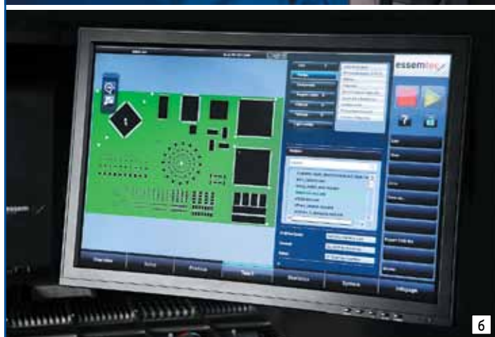
Рис. 8. Управление автоматом через графический интерфейс
