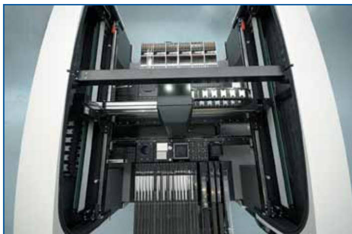
Рис. 5. Индивидуальные и блочные питатели, установленные с двух сторон
