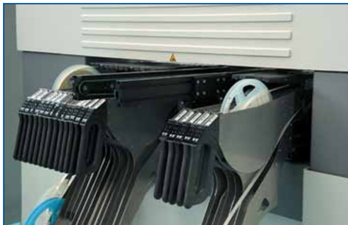
Рис. 3. Индивидуальные питатели, установленные с торцевой стороны автомата
