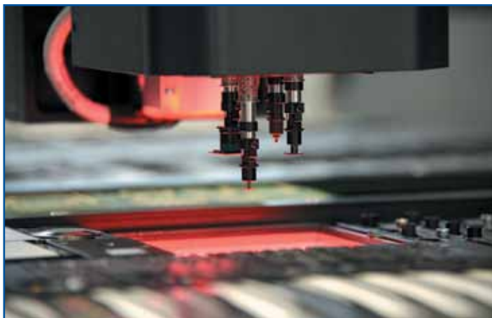
Рис. 2. Одновременное центрирование четырех компонентов
