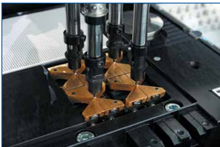
Рис. 7. Одновременное тестирование компонентов на верификаторе
