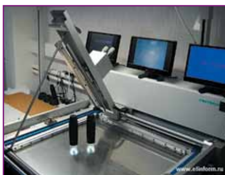
Рис. 2. Установка трафаретной печати Fritsch SD903 с внешними камерами для совмещения трафарета
