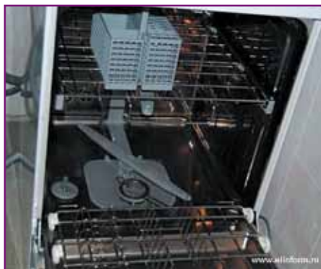
Рис. 6. Установка струйной отмывки Око2000mp
