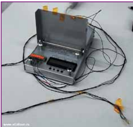
Рис. 5. Термоскоп TA-570 М производства «Техно-Альянс Электроникс»
