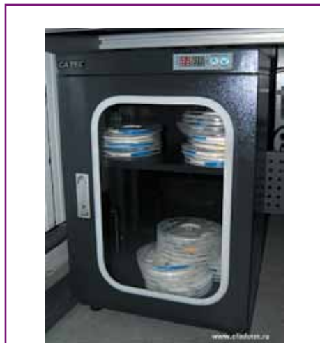
Рис. 8. Шкаф сухого хранения Catec
