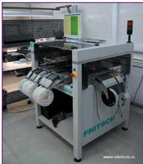
Рис. 3. Автомат установки компонентов Fritsch PlaceAll PA510
