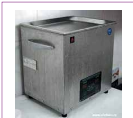
Рис. 7. Установка УЗ-отмывки ПСБ-9535-05м
