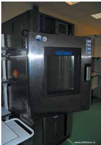
Рис. 9. Испытательная климатическая камера МНС-120 CNSA
