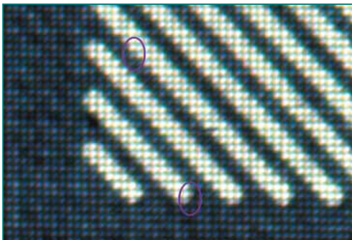
Рис. 8. Дефекты на трафарете
