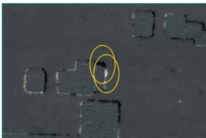
Рис. 12. Дефект площадки, обнаруженный прямым сравнением двух керамических листов
