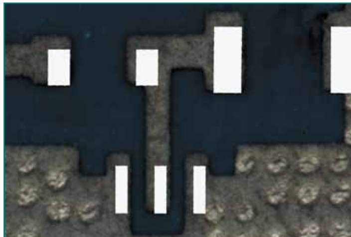
Рис. 14. Совмещение готовой платы и эталона трафарета припойной пасты
