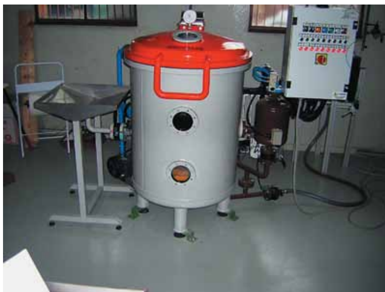
Рис. 9. Установка без бака подготовки
