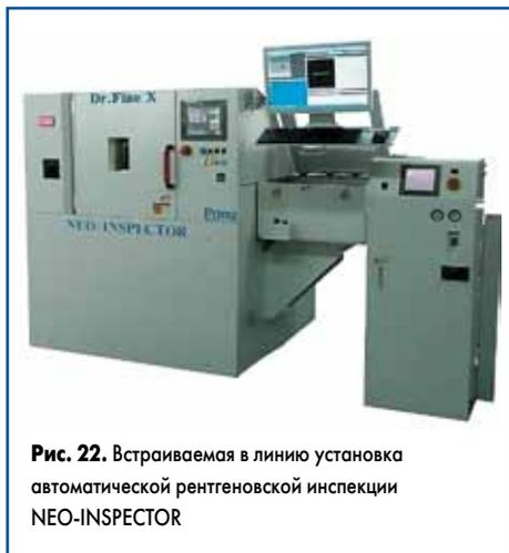
**Рис. 22.** Встраиваемая в линию установка автоматической рентгеновской инспекции NEO-INSPECTOR
