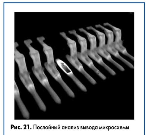
Рис. 21. Послойный анализ вывода микросхемы
