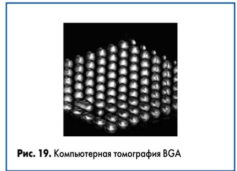
Рис. 19. Компьютерная томография BGA
