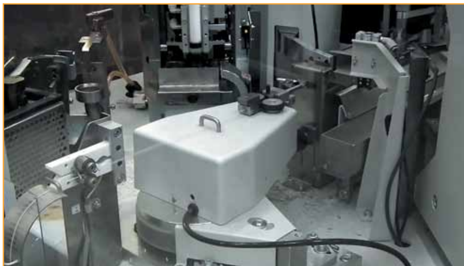
Рис. 4. Автоматическая линия обработки провода с модулями лазерной зачистки, подкрутки, флюсования и лужения
