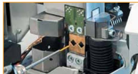
Рис. 3. Модуль контроля касания жилы для автоматической линии обработки провода
