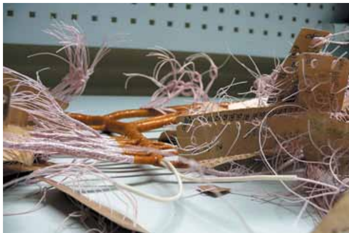
Рис. 1. Жгутовая сборка с применением провода МГПФ
