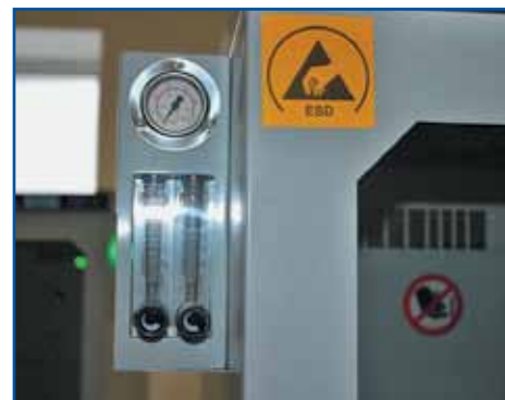
Рис. 3. Антистатическое исполнение автоматизированных систем сухого хранения производства российской компании «Совтест АТЕ»
