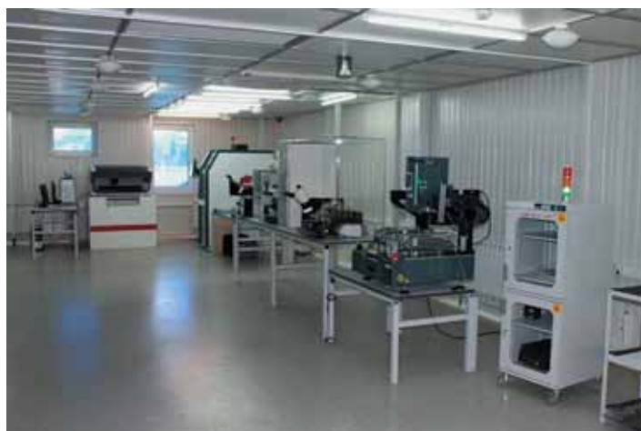
Рис. 6. Системы сухого хранения SDB применяются на собственном производстве компании «Совтест АТЕ»
