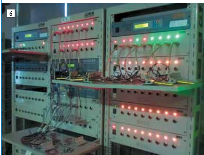
Рис. 4. Система тестирования Li-ion-аккумуляторов: а) цилиндрических; б) плоских
