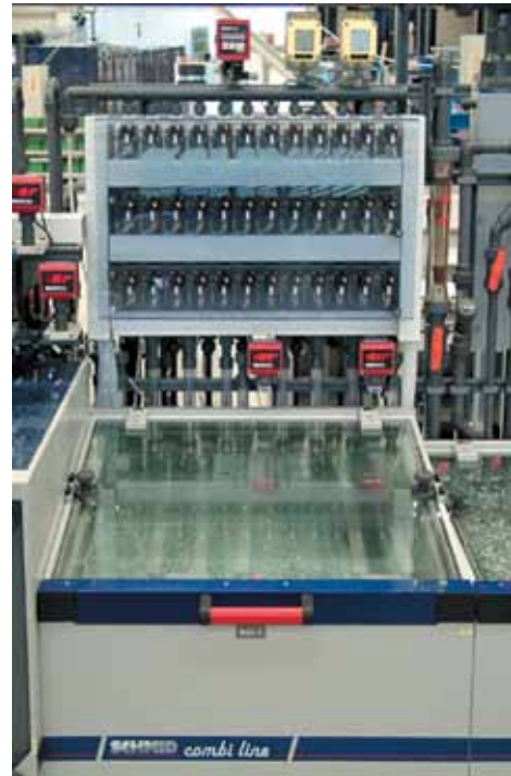
Рис. 5. Блок интермиттирующего травления с индивидуальным управлением форсунками
