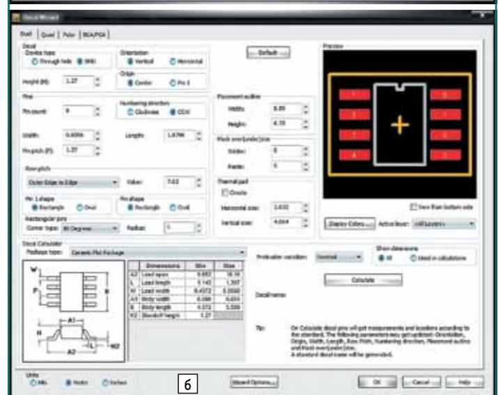
Рис. 8. Создание посадочного места компонента на вкладке Dual мастера посадочных мест Decal Wizard: а) со штырьковыми выводами; б) с планарными выводами
