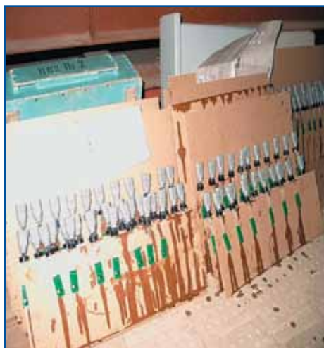
Рис. 2. Бракованная продукция после ручной заливки двухкомпонентным компаундом
