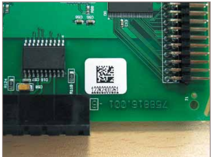
Рис. 6. Пример маркировки печатной платы
