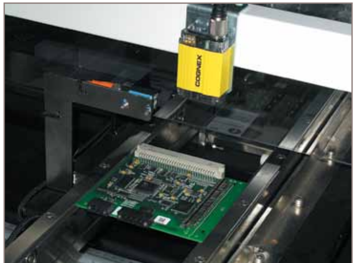
Рис. 7. Считывание маркировочной метки с печатной платы на конвейере
