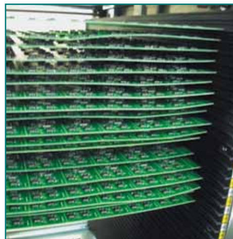
Рис. 16. Мультиплицированные платы с дефектом «уменьшение ширины перешейка» в накопителе после прохождения печи
