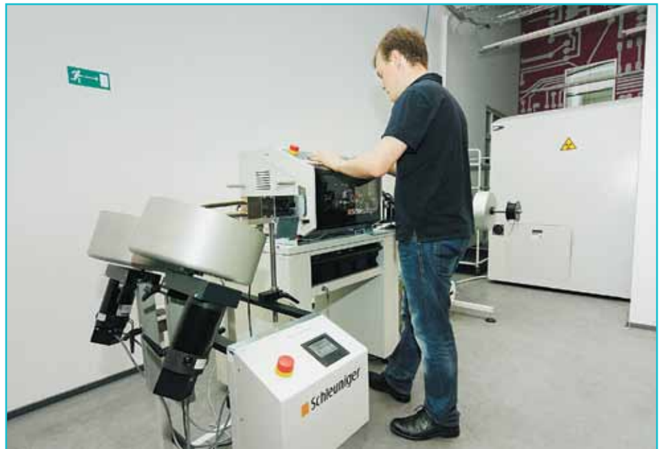
Рис. 5. Автоматическая линия мерной резки, зачистки и нанесения маркировки на основе машины Omni Strip 945
