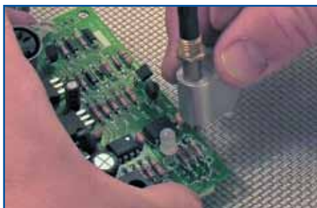
Рис. 6. Пример снятия влагозащитного покрытия с помощью установки Swam Blaster Turbo Max
