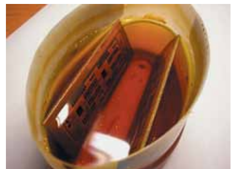
Рис. 2. Вымачивание печатного узла в растворителе для снятия УР-231
