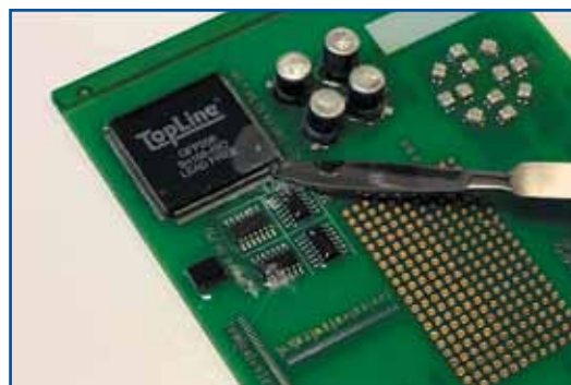
Рис. 1. Снятие влагозащитного покрытия с помощью скальпеля
