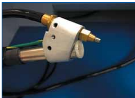
Рис. 4. Блок наконечника распыления абразива с форсункой и микроионизатором
