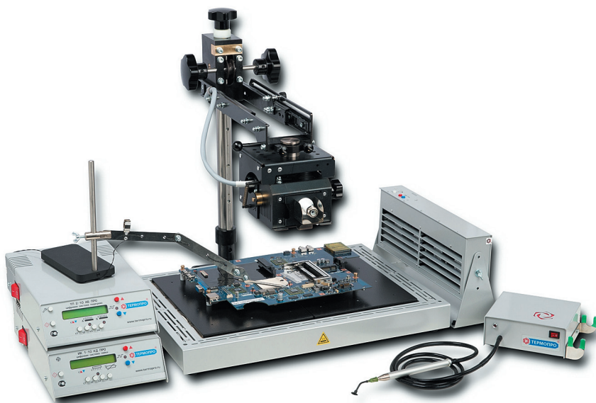
Рис. 5. Профессиональный ИК ремонтно-паяльный центр ТЕРМОПРО ИК-650 ПРО
