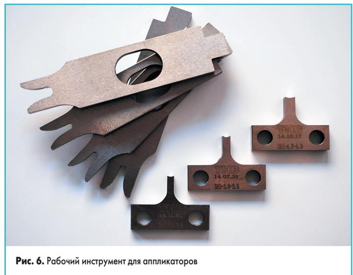
**Рис. 6.** Рабочий инструмент для аппликаторов
