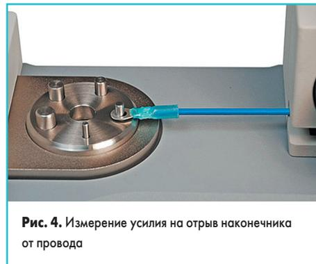
**Рис. 4.** Измерение усилия на отрыв наконечника от провода
