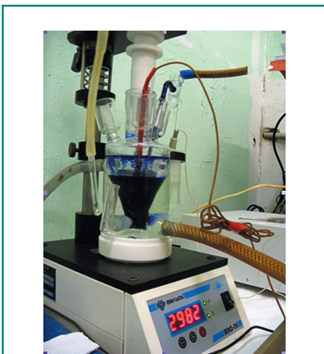
Рис. 2. Установка дискового вращающегося электрода с термостатированной ячейкой
