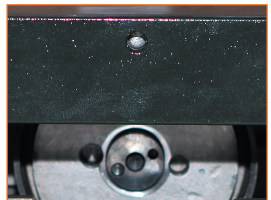
Рис. 2. Регулируемый эксцентрик вибротестера (модель 9363M)
