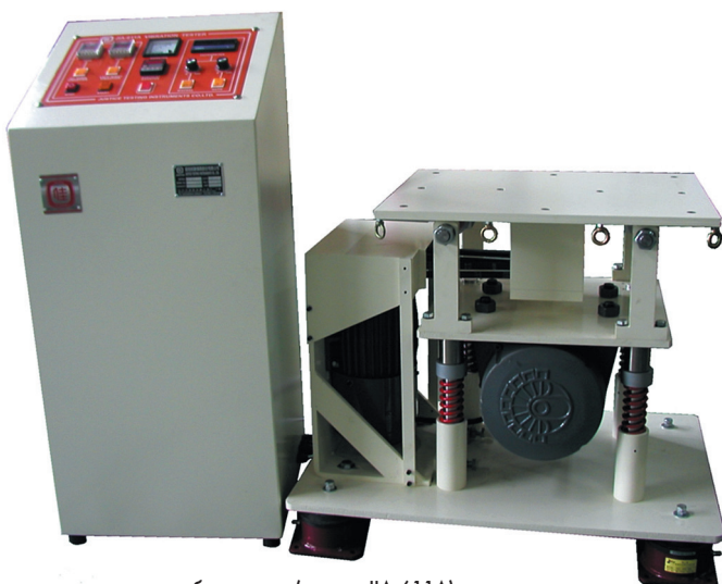
Рис. 1. Типичная конструкция вибротестера (модель JIA-611A): блок питания — управления частотой и вибростол
