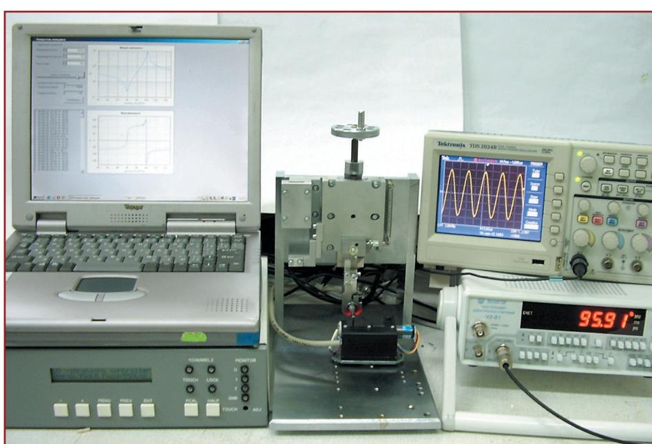
**Рис. 11.** Стенд контроля колебаний СКК-01
