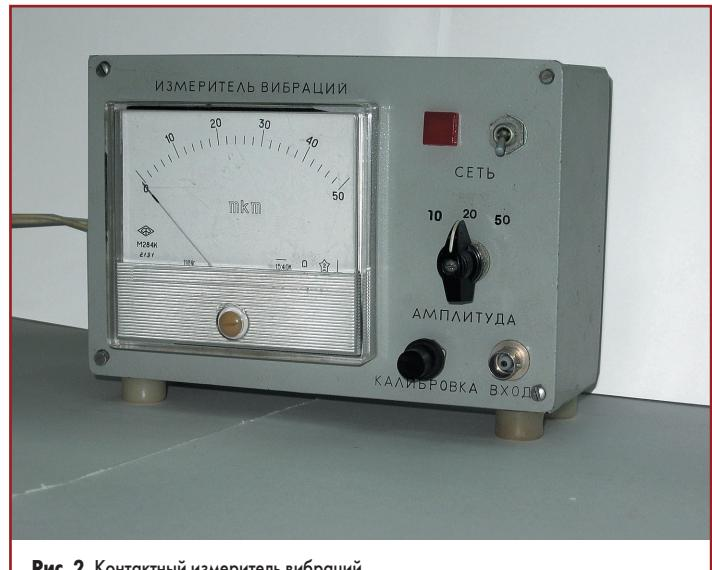
**Рис. 2.** Контактный измеритель вибраций
