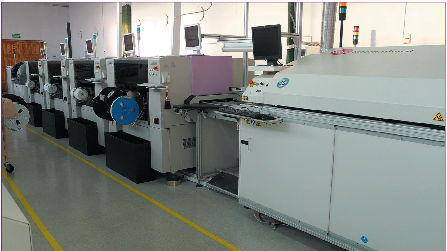
Рисунок. Линия поверхностного монтажа печатных плат
