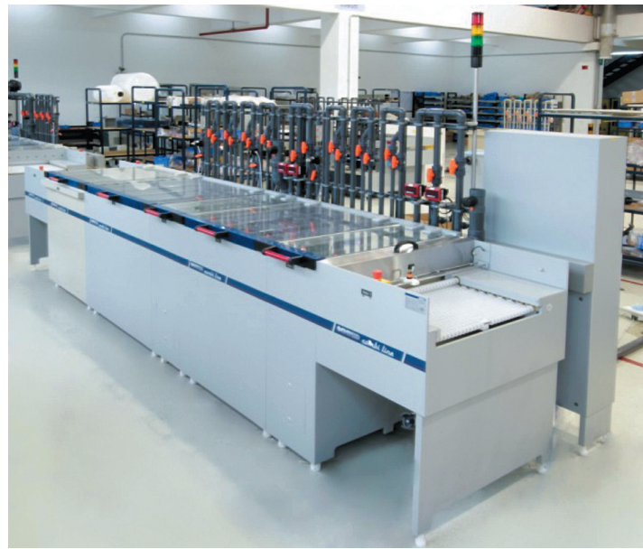
Рис. 3. Установка микротравления (Microetching line) фирмы «Шмид»
