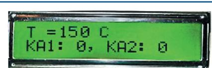
**Рис. 5.** Внешний вид ЖКИ с измеренной температурой и статусом реле
