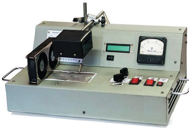
**Рис. 6.** Устройство инфракрасной пайки со средневолновым керамическим излучателем, установленным в качестве верхнего нагревателя
