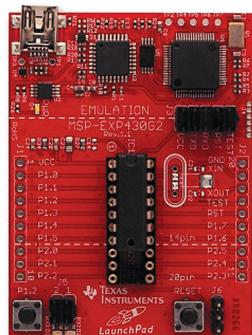
**Рис. 1.** Микроконтроллер MSP430 с отладочной платой
