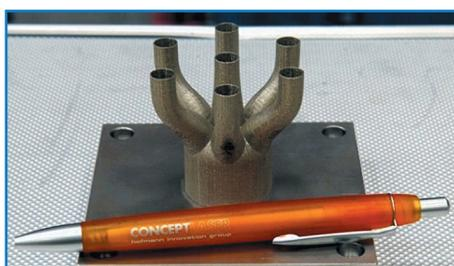
Рис. 3. Детали для ракетных двигателей J-2X и RS-25 из никелевых сплавов
