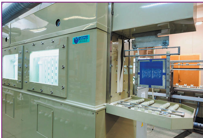
Рис. 1. Новый процесс аминосульфатного травления. Автоматизированная установка «Элтрахим»
