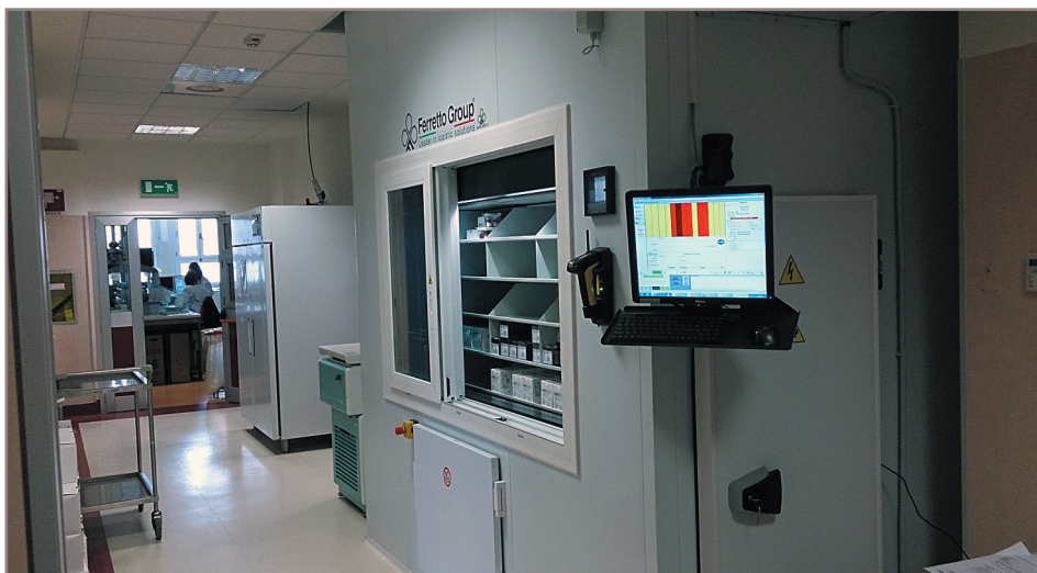
Рис. 7. Автоматизированная система хранения с возможностью поддержания климатических условий
