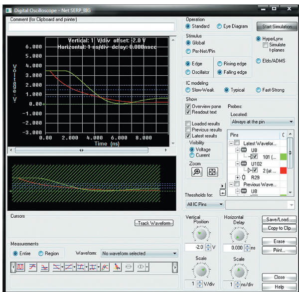
Рис. 16. Временная диаграмма заднего фронта импульса после согласования (красная кривая — напряжение на передатчике, зеленая кривая — напряжение на приемнике)
