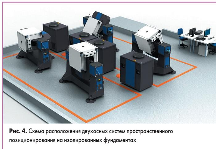
Рис. 4. Схема расположения двухосных систем пространственного позиционирования на изолированных фундаментах
