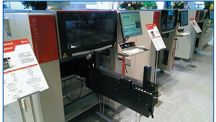
Рис. 5. Автоматы установки компонентов MI-серии для автоиндустрии
