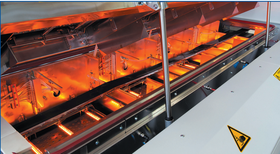
Рис. 2. Вид открытой сушки для пленки
