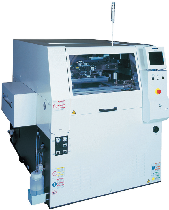
Рис. 2. Установка трафаретной печати Panasonic SPG
