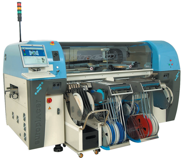
Рис. 3. Автоматический сборочно-монтажный комплекс установки компонентов поверхностного монтажа Europlacer iineo
