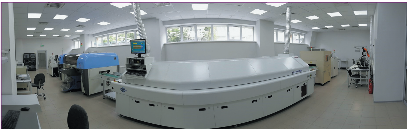
Рис. 1. Автоматизированная линия установки и пайки поверхностно монтируемых компонентов на печатные платы
