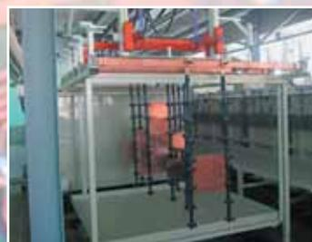
Современные отечественные гальванические линии для производства ПП высокого класса
