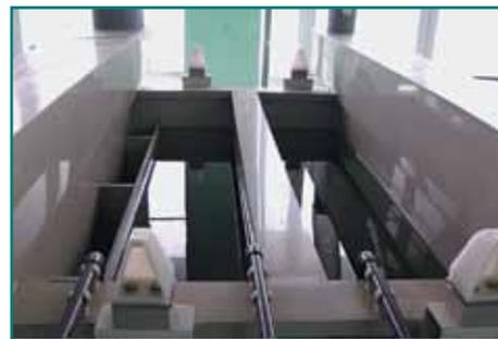
**Рис. 6.** Ванна двухкаскадной промывки
