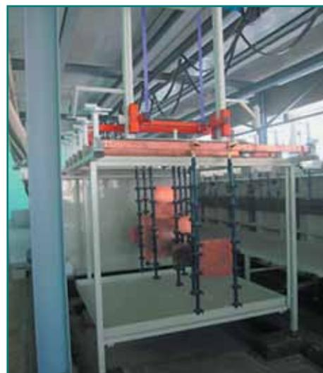
**Рис. 7.** Подвески с покрытием ПВХ
