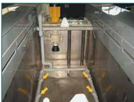
**Рис. 3.** Ванна с безвоздушным перемешиванием
