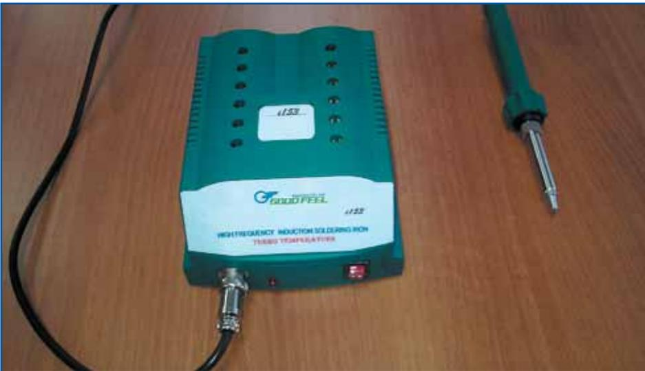
Рис. 2. Индукционная паяльная станция I153ESD
