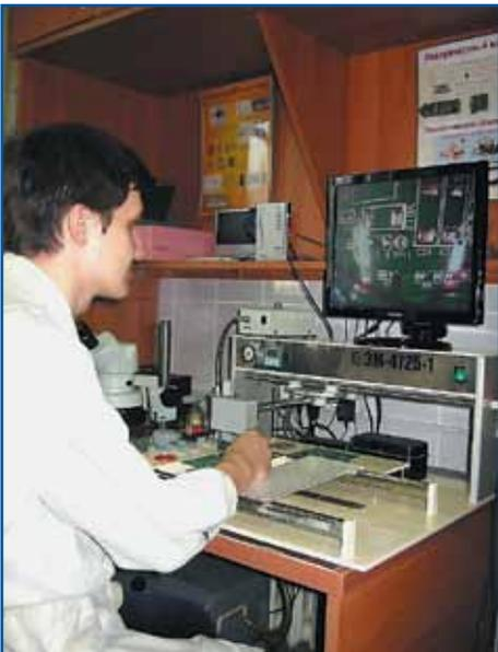
Рис. 6. Рабочее место установки SMD-компонентов
