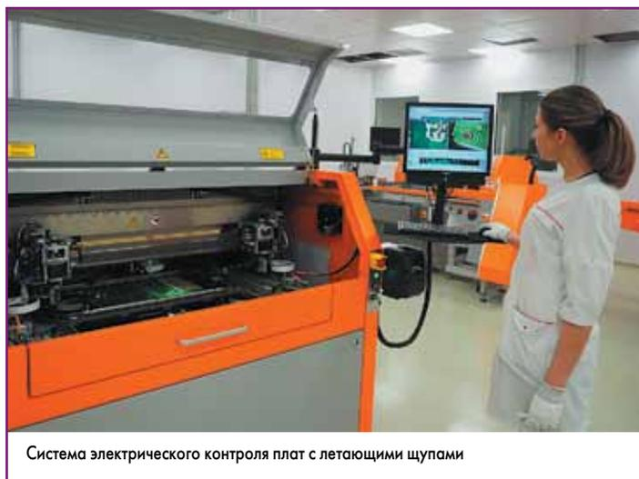
Система электрического контроля плат с летающими щупами
