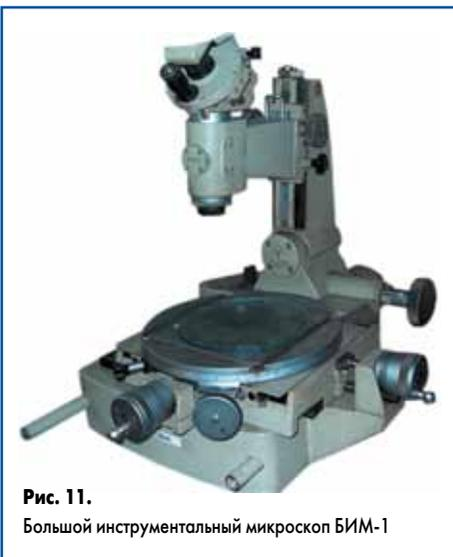
**Рис. 11.** Большой инструментальный микроскоп БИМ-1
