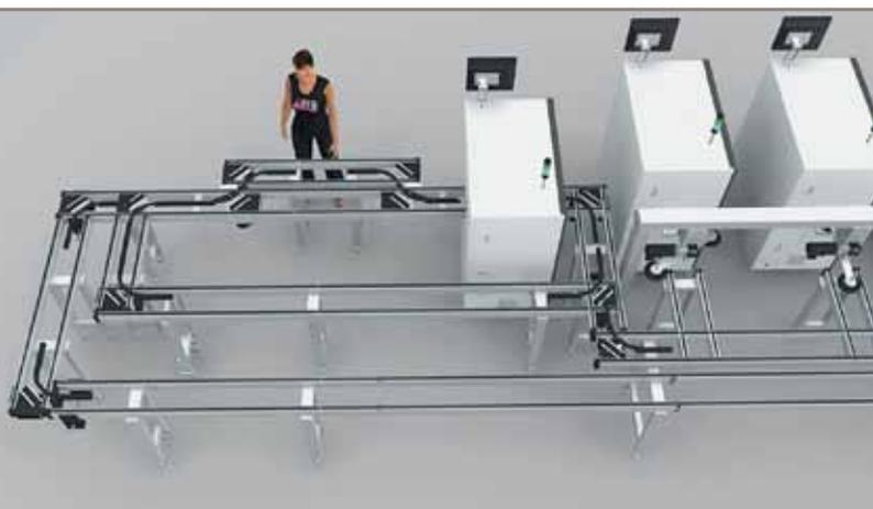
Рис. 11. Конвейерные системы ASYS TECTON MOTUS
