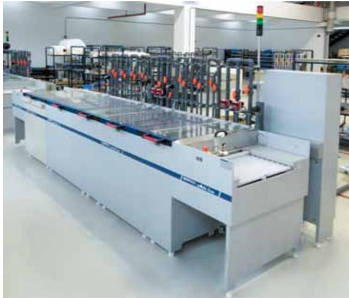
Рис. 3. Установка микротравления (Microetching line) фирмы «Шмид»
