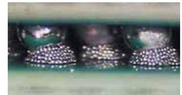
Рис. 4. Контакт шариков BGA-компонента и паяльной пасты
