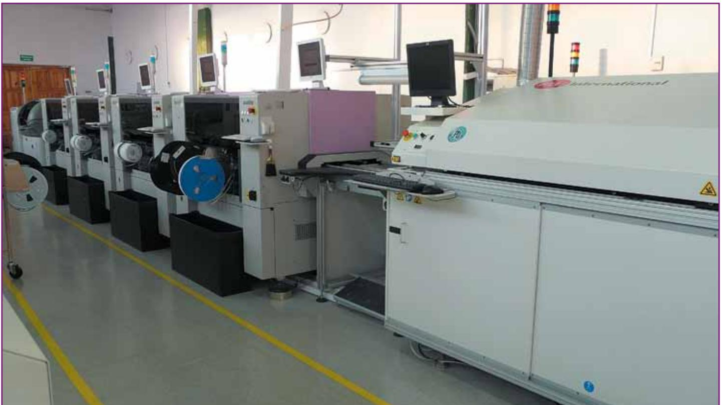
Рисунок. Линия поверхностного монтажа печатных плат
