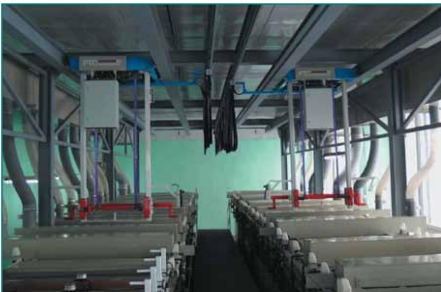
**Рис. 1.** Химико-гальваническая линия с подвесными автооператорами
