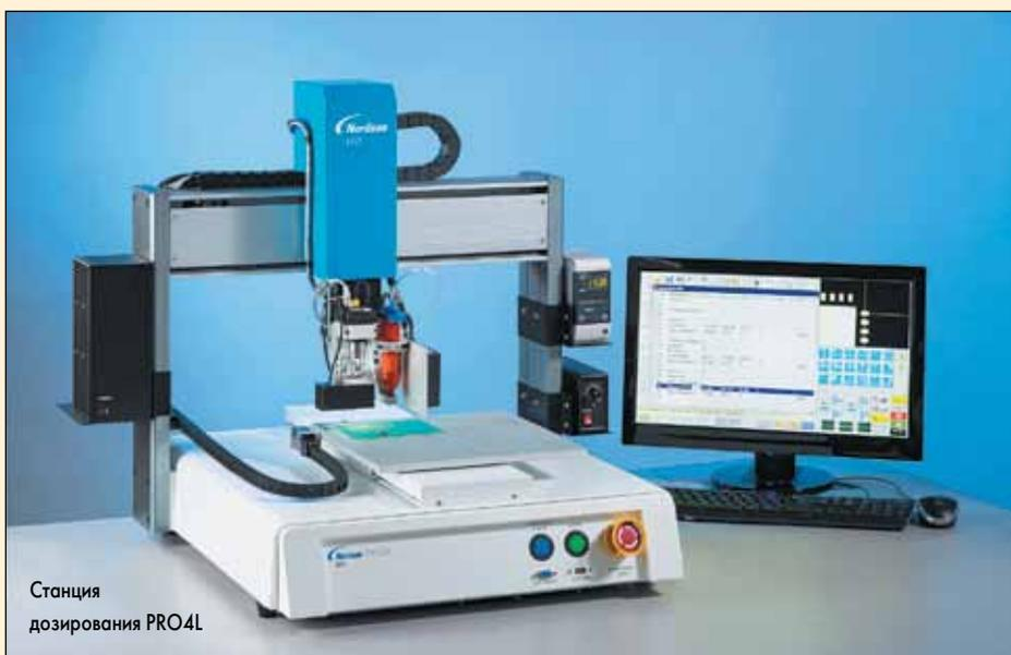
много быстрее, так как машину проще обучить и сразу же увидеть исполнение программы дозирования с учетом заданных параметров. Система обратной связи робота постоянно проверяет фактическое состояние для того, чтобы обеспечить полную управляемость в течение всего процесса дозирования. Презентовав новую серию PRO, EFD дает своим клиентам целую палитру новых опций и возможностей для дозирования».
