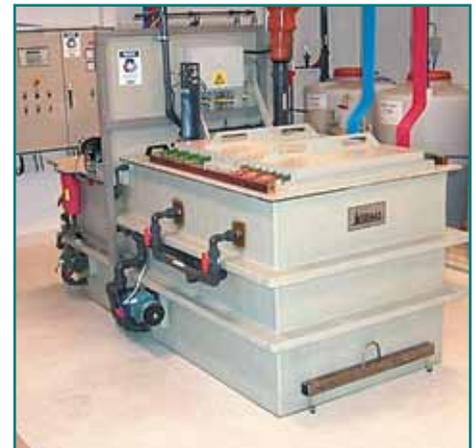
Рис. 11. Установка регенерации травильных растворов фирмы «Сигма» (Швеция)
