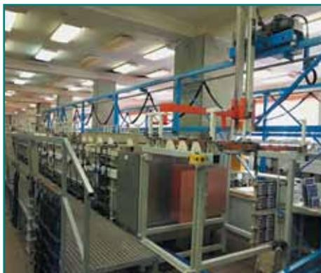
**Рис. 2.** Химико-гальваническая линия с консольным автооператором
