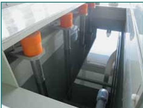
**Рис. 9.** Ванна с патронными нагревателями
