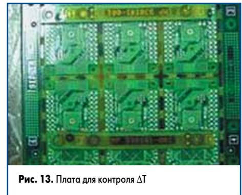
**Рис. 13.** Плата для контроля  $\Delta T$
