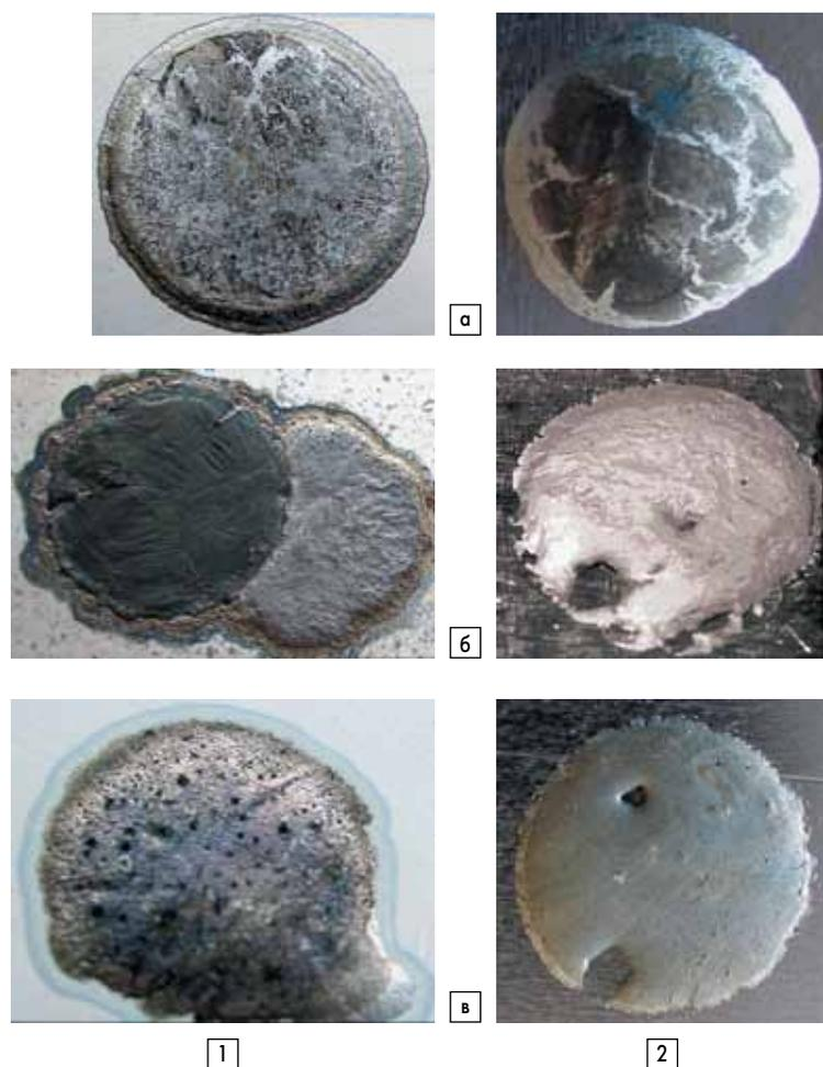
**Рис. 4.** Внешний вид растекания припоя 87–89Sn/9–11Bi/0,8–1,2Sb (вес. %) по серебряному покрытию кристалла (1) и по никелевому покрытию корпуса (2) при нагреве в различных средах: а) в водороде; б) в формир-газе; в) в вакууме
