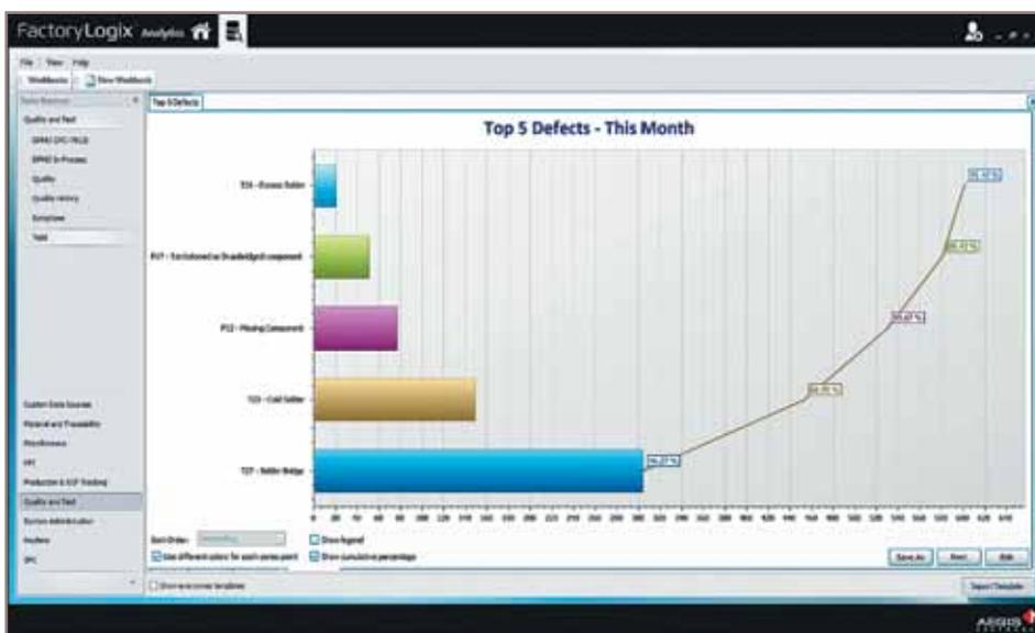
Рис. 2. Диаграмма наиболее распространенных дефектов, обнаруженных в течение месяца
