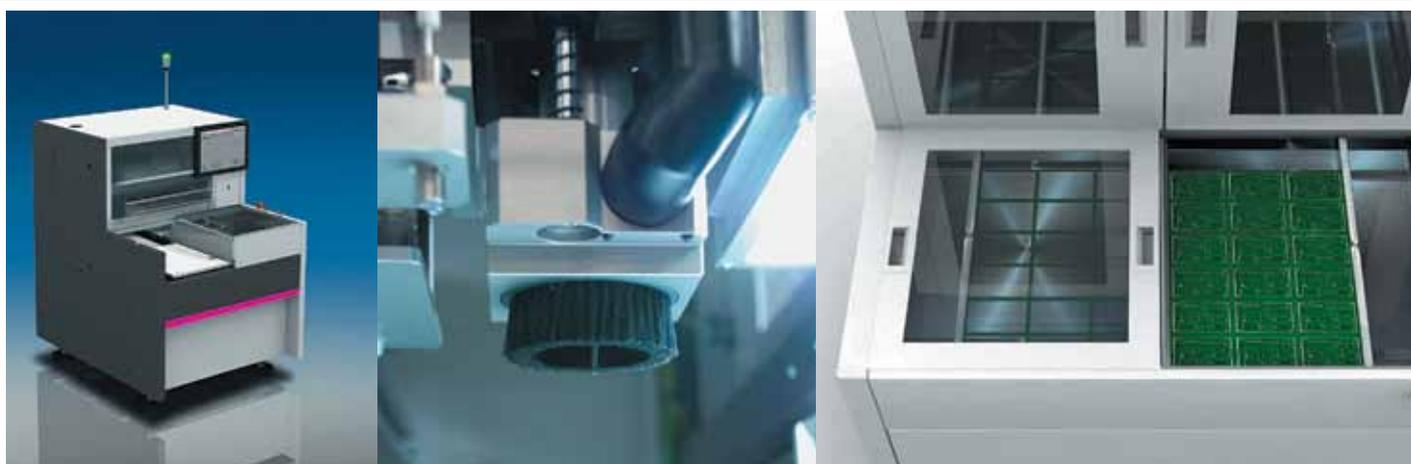
Рис. 4. Система разделения групповых заготовок DIVISIO 1000
