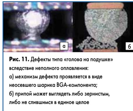
**Рис. 11.** Дефекты типа «голова на подушке» вследствие неполного оплавления: а) механизм дефекта проявляется в виде неосевшего шарика BGA-компонента; б) припой может выглядеть либо зернистым, либо не слившимся в единое целое
