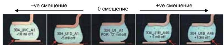
Рис. 9. Смещения различных панелей. Полученные с помощью оптического микроскопа фотографии поперечных сечений смещенных контактных панелей BGA на тестовом образце платы
