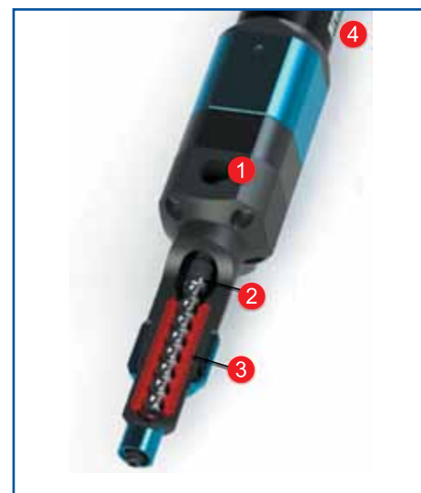
Рис. 13. Устройство эксцентрикового шнекового клапана: 1 — дозатор; 2 — ротор; 3 — эластомерный статор
