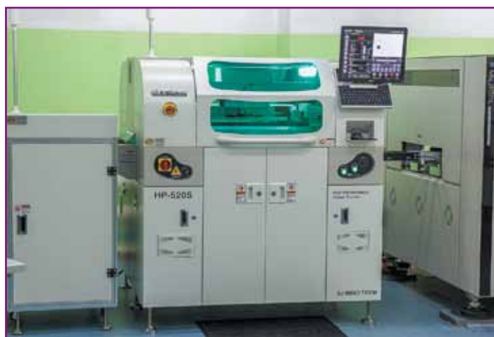
Рис. 5. Автоматический скоростной прецизионный принтер для нанесения пасты на печатные платы SJ InnoTech HP-520. Поставщик ООО «ЛионТех»
