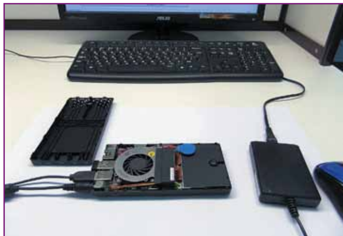
Рис. 3. Печатная плата компьютера Raydget, прошедшая проверку после монтажа компонентов и установленная в корпус устройства
