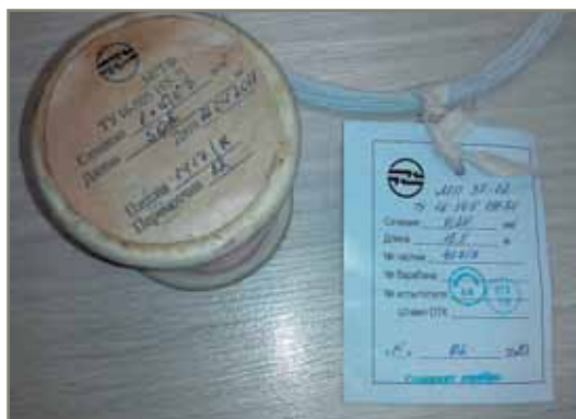
Рис. 1. Проводные заготовки, промаркированные бумажными бирками заводом-изготовителем
