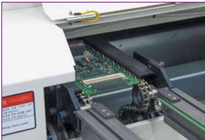
Рис. 2. Печатная плата самого маленького высокопроизводительного компьютера на выходе линии по сборке SMD-монтажа
