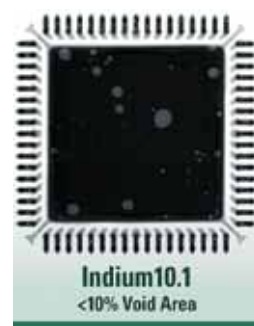
Рис. 2. Низкое образование пустот при использовании паст производства Indium Corporation
