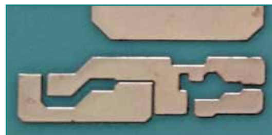
Рис. 1. Опытный образец платы источника тока, где толщина медных структур на AlN-основании составляет (100 \pm 5) мкм, минимальный зазор — 200 мкм
