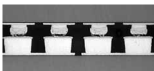
Рис. 1. Поперечное сечение сборки с применением NCF (усилие прижима 500 Н)
