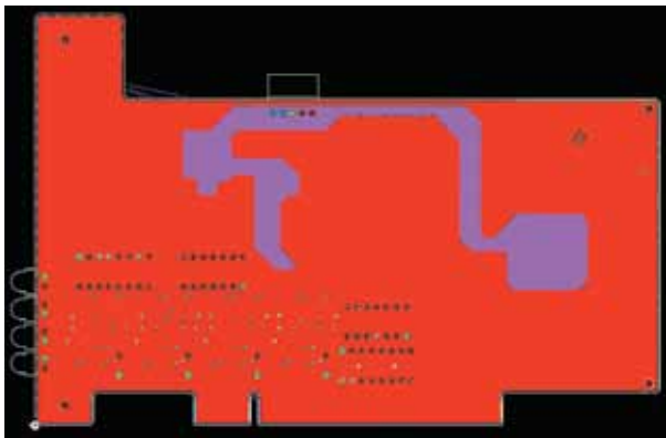
Рис. 31. Смешанная область металлизации Split-типа, разделенная на две области с разными напряжениями
