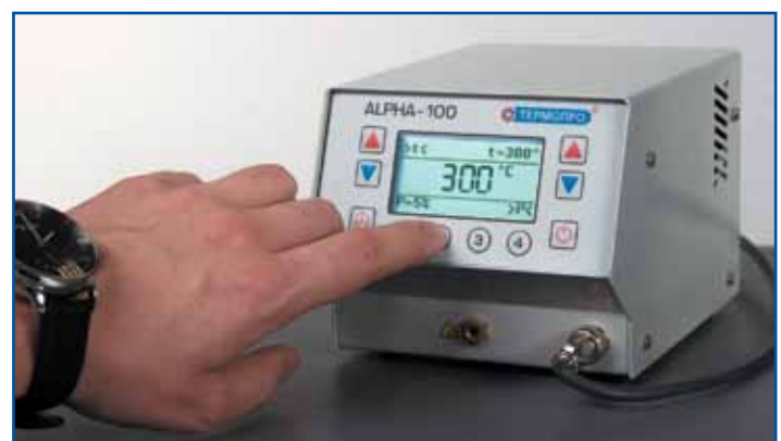
Рис. 7. Запись заданной температуры в ячейки памяти для быстрой смены настроек
