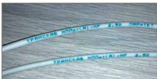
Рис. 2. Маркировка проводов методом струйной печати заводом-изготовителем
