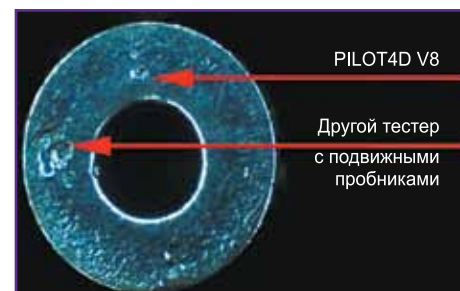
Рис. 6. Повторяемость позиционирования пробников Pilot4D V8 в сравнении с другими тестерами с подвижными пробниками
