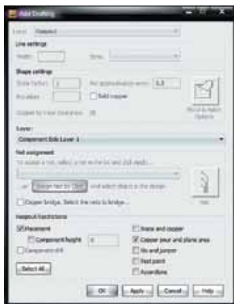
Рис. 17. Выбор элементов платы в окне Add Drafting для запрета их размещения в области Keerout
